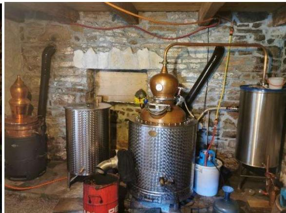
Drozga doseže cca. 100 stopinj celzija in alkohol se upari. Para se dvigne in po cevi potuje proti hladilniku kotla, ki paro ohladi in ta se spremeni v tekočino mlečne barve. To se imenuje »žonta«.
